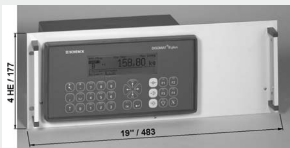
19" Baugruppenträger VNG 20400 mit Einbaugerät VEG 20400 Tiefe 195 mm + 25 mm für Anschlusskabel Schutzart: Front IP 54 sonst IP 20 Gewicht: 7,5 kg
