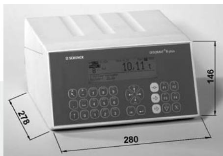
Tischgerät VTG 20400 Schutzart: IP54, Kunststoff, 10 Kabeleinlässe inkl. Netzanschluss und Wägezellenkabel Gewicht: 3,7 kg
